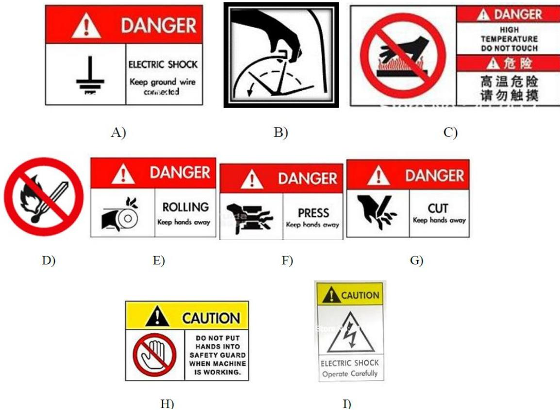
Figura 28. Señales de seguridad que se encuentran en las máquinas
