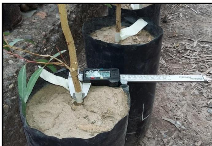
**Figura N°15:** Medición del diámetro en el cuello de la planta.
