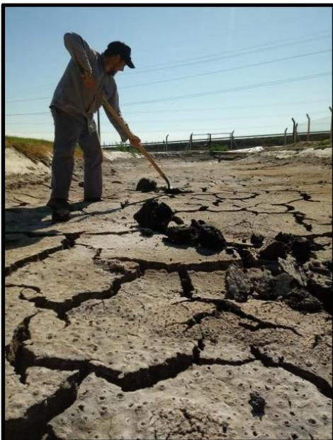
**Figura N°8:** Extracción de la muestra de lodo.
