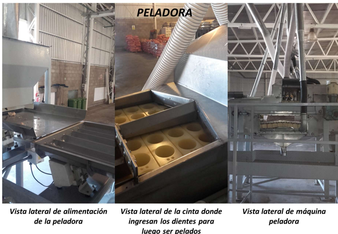
Figura 8. Peladora de ajos.
