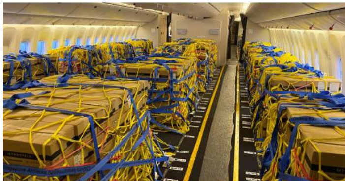
Imagen 14: Boeing 777 Air Canadá con la cabina de pasajeros con asientos removidos cargada de pallets
