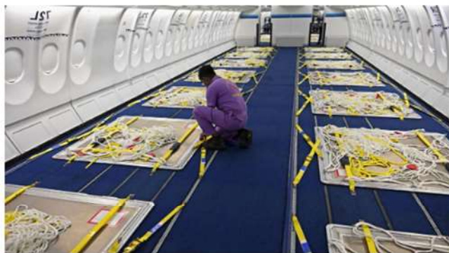
Imagen 13: Boing 777 Air Canada con la cabina de pasajeros con asientos removidos con la señalización para pallets
