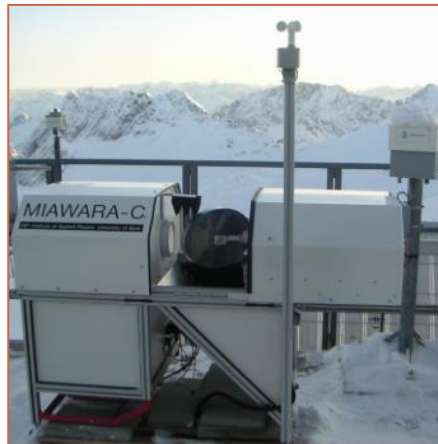
FIGURA 4: RADIÓMETRO MIAWARA-C INSTALADO EN ZUGSPITZE. FUENTE: STRAUB ET AL., 2010
